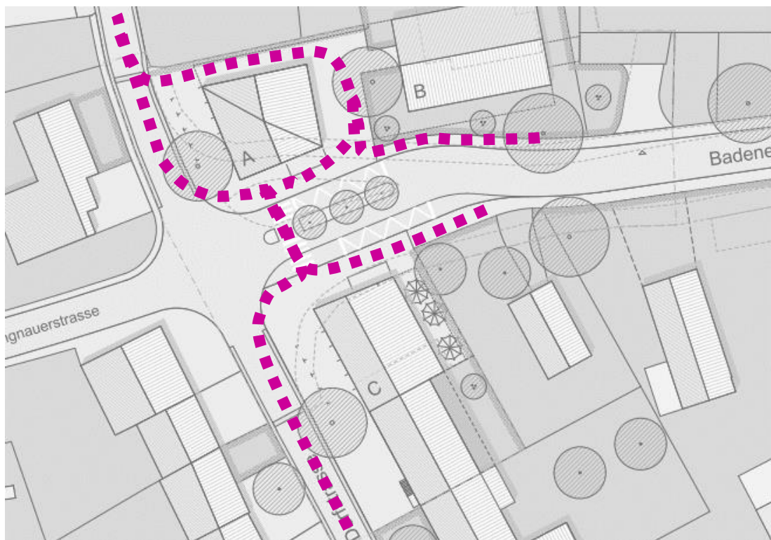
Abbildung 13: Fussgängerführung im Bereich der Kantonsstrassenquerung
